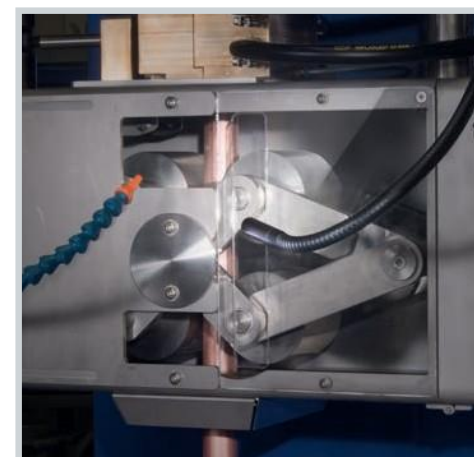
Lijevo u prednjem planu je dodatni SEKUNDARNI RASHLADNI SISTEM, s desne strane pomični LED reflektor za jednostavniju kontrolu dovoda.
