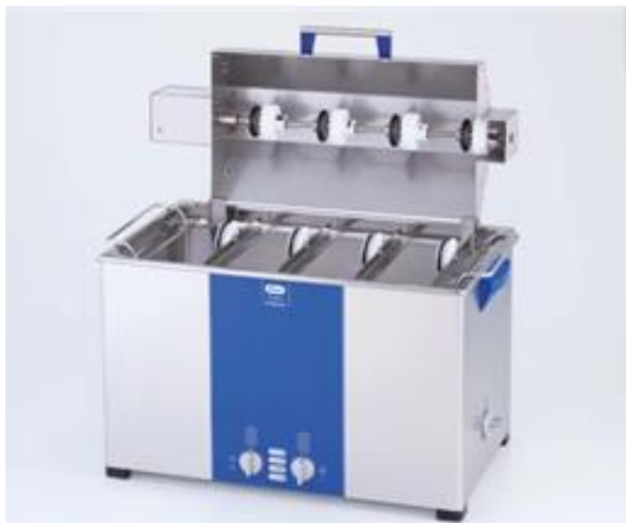
Elmasonic S 300 (H) sa umetnutim SRH 4/200 modulom za sita
