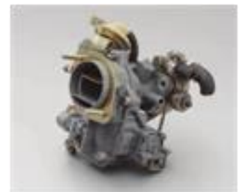
rasplinjač očišćen s Elma Sonic S80 i Elma Tec Clean A5
