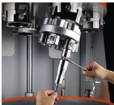
Nagnuti držač sa vlastitom rotacijom Izborno raspolaže kosim položajem držača i tako omogućava obradu čeonih površina i kompleksnih geometrija.
