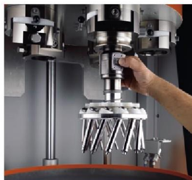
Kruti držač Kruti držač sa sustavom za brzo stezanje
