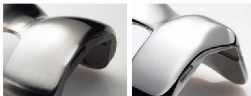
Primjer: visoko sjajno polirana površina Ra = 0,01 µm
